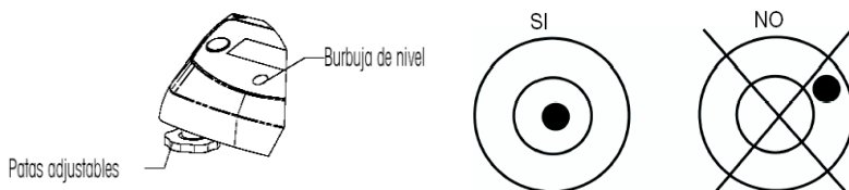
Figura 2-1. Nivelación de la báscula.
